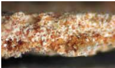
Vue transversale d'une goutte de badigeon coloré d'origine sous microscope: dans la masse blanche du liant (chaux), on reconnaît les fragments de tuile pilée ayant servi de pigment
