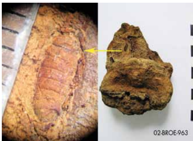
Afdruk van een vliegenpop in de corrosie van een ijzeren gesp, Broechem (© VIOE)
