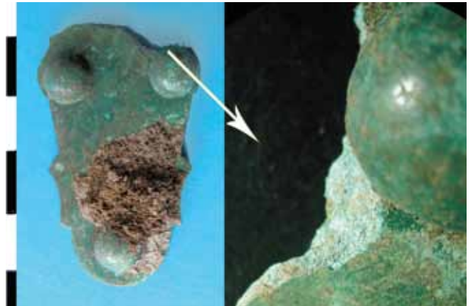
Koperlegering uit Broechem waarbij de detailopname duidelijk maakt in welke mate het object volledig verpoederd is en hoe de flinterdunne patina aan de buitenzijde het geheel nog samenhoudt (© VIOE).
