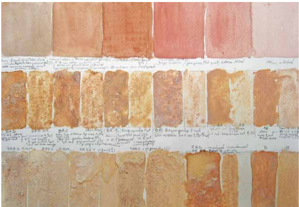
Essais d'étalonnage à l'aquarelle des teintes originales retrouvées, puis préparations à la chaux, poudre de brique et quantités minimales de pigment en poudre servant à ajuster la teinte
