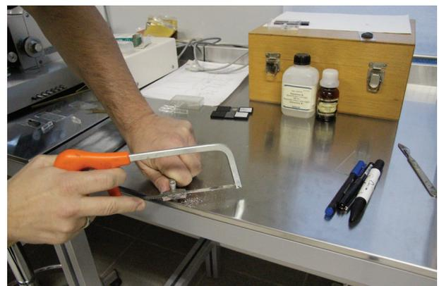
fig.4: sciage du bloc jusqu'à proximité de l'échantillon, avec une petite pince pour le maintenir
