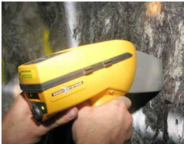
*Fig. 1: Voorbeeld van een handmatig gebruikt XRF-toestel bij het meten van erts om de aanwezige metalen te bepalen. (Toestel Innov-X Systems) Exemple d'utilisation d'un XRF portable, ici l'analyse d'un minerai, pour déterminer les métaux présents (appareil Innov-X systems)*
