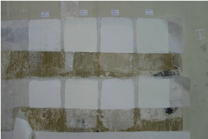
Fig. 2 A en B : Lier, Begijnhofkerk : tests pour overdekking et herkalking van een barokinterieur met plaatselijk verbergen van de 19de-eeuwse polychromie en eveneens voor het verwijderen van deze nieuwe lagen.
