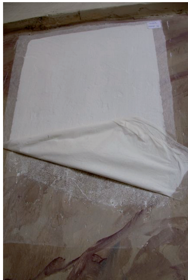
Fig. 2 A en B : Lier, Begijnhofkerk : tests pour overdekking et herkalking van een barokinterieur met plaatselijk verbergen van de 19de-eeuwse polychromie en eveneens voor het verwijderen van deze nieuwe lagen.
