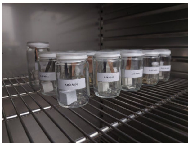
Fig. 3 : Série d'échantillons imprimés en 3D préparés pour le test de vieillissement accéléré selon le protocole du test d'Oddy (3 en 1) du British Museum. ©PatriciaVieiraPinto
